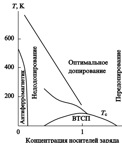
Рис. 3. Обобщенная диаграмма состояния высокотемпературного сверхпроводника в зависимости от приведенной концентрации носителей заряда в сверхпроводящих плоскостях.
